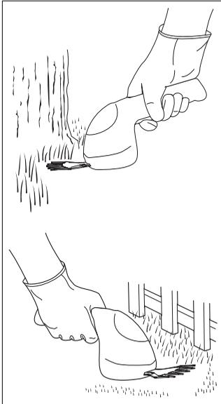
本機を図のように持ち（もう一方の手は刃から十分に離す）、スイッチを入れ、乾いた芝生の上を滑らせるように前進してください。
