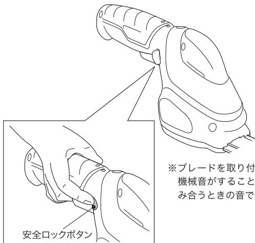
※ブレードを取り付けた後に、初めて本機を動作させた際、ガチャと大きめの機械音することがあります。これはブレードの可動部とモーターの軸がかみ合うときの音で、故障ではありません。
